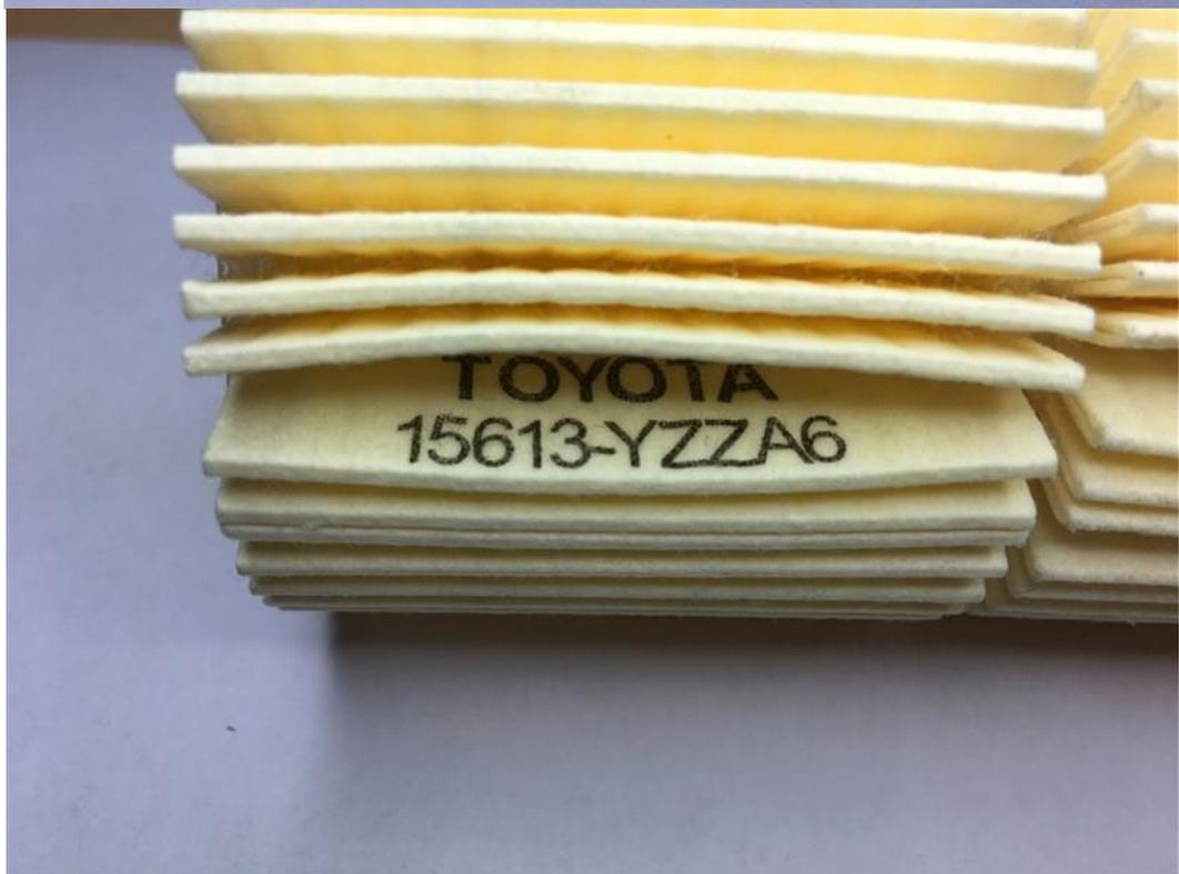
Во-вторых, отличается шрифт печати марки и номера изделия на фильтрующем материале. На оригинальном изделии надпись выполнена закругленным жирным шрифтом, на представленном на экспертизу образце – обычным, без засечек.
